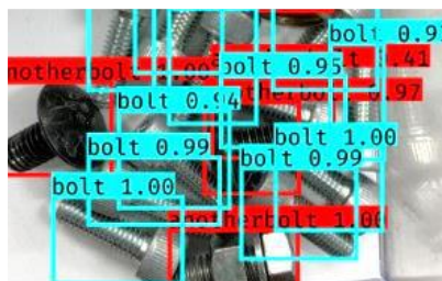
図2 検出したねじと位置の表示例
